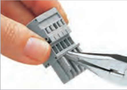
Кодировка розетки – выломайте кодировочные выступы. Не удаляйте первый и последний кодировочные выступы.
