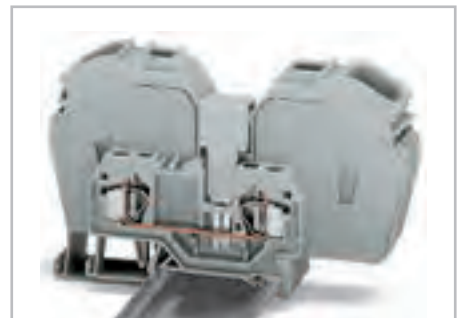
Переходная перемычка 283-414 может также объединять проходные клеммы 35 мм 2 (AWG 2) 285-635 с проходными клеммами 4 мм 2 (AWG 12) 281-901 . Сведения о проходных клеммах 35 мм 2 /AWG 12, см. на стр. 194.
