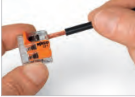
Подключение проводника: откройте зажимное устройство с помощью рычага и вставьте проводник.
