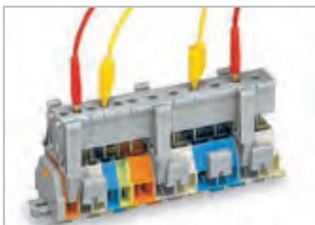
Для измерения модули тестового штекера устанавливаются в клеммную колодку – с проводом или без. Как только произошел контакт с элементом CAGE CLAMP® (нержавеющая сталь), данный тип будет ограничен до 0,5 А.
