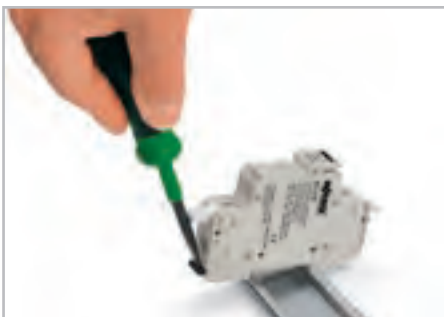
Снимите клемму с несущей рейки.
