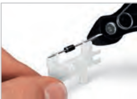
Обрезка компонента до необходимой длины.
