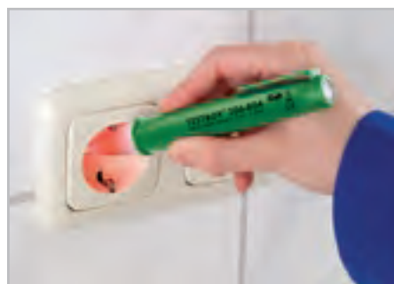
Устройство, которое достоверно определит напряжение перем. тока в кабеле, розетке, предохранителе, переключателе, выходе, и т.п.
