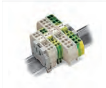
Торцевая и промежуточная пластина Для выполнения требований по утечке и зазору для применений Ex e, необходимо вставить торцевую или промежуточную пластину между проходной клеммой и клеммой с заземлением.
