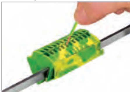
Клеммы CAGE CLAMP®S для вставного соединения позволяют вставлять одножильные проводники прямо в блок сборной шины 12 x 4 мм 2 /AWG 12, что значительно сокращает время проводного монтажа.
