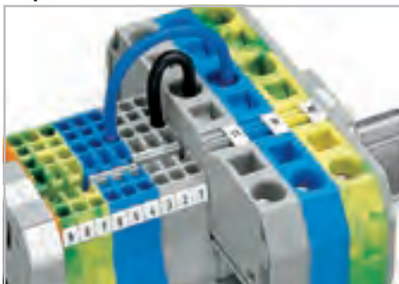
Объединение перемычками клемм разных размеров - ступенчатые перемычки.
