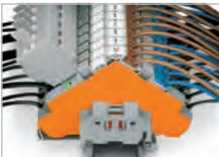
Штекерный предохранитель на 1 мм шире клеммы. Это говорит о необходимости установки промежуточной пластины.
