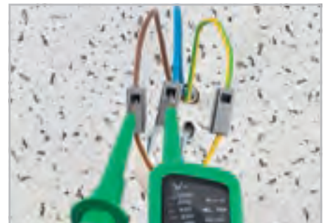
Измерение через отдельное тестовое гнездо.
