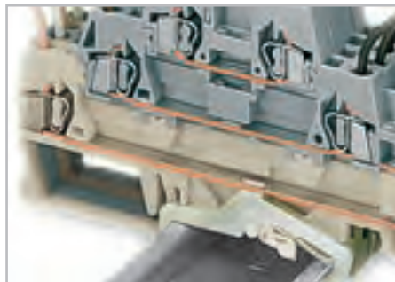
Клеммы с заземлением или экранированные клеммы имеют контактную опору на нижнем уровне, которая автоматически устанавливает контакт с несущим рельсом. Гибкий держатель маркировки, размещенный выше уровня кабеля может быть отстранен во время прокладки кабеля или объединения перемычками. Держатель маркировки имеет три уровня для трех различных маркеров WMB, связанных с трехуровневой клеммой. При ширине клеммы всего 5 мм, эффективная ширина в 1,67 мм для клемм того же или иного потенциала может быть достигнута при площади поперечного сечения 0,08 мм 2 ... 2,5 мм 2 (AWG 28 ... 14).
