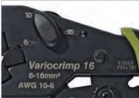
Только для "VarioCrimp 16": Ручкой на инструменте установите сечение проводника в открытом положении.
