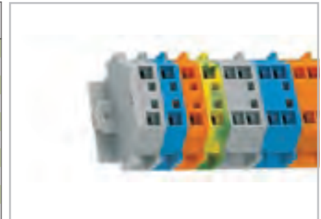
Клеммная колодка с крепежными фланцами, для винтового или аналогичного способа крепления, крепежное отверстие 3,2 мм Ø (с монтажным адаптером 209-123 также для DIN-рейки 35 мм)
