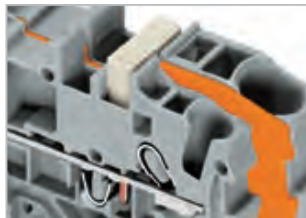
Объединение переходными перемычками Между соединяемыми клеммами необходимо вставить торцевую пластину. Переходная перемычка 2016-499 объединяет клеммы 16/10 мм 2 /AWG 16/8 (серии 2016/2010) с клеммами 10/6/4/2,5 мм 2 /AWG 8/10/12/14 (серии 2010/2006/2004/2002). Переходную перемычку просто необходимо надавить вниз до упора, подобно другим гребешковым перемычкам.
