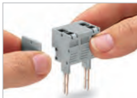
Соединение тестового штекера и модулей разделителей с разделительной пластиной для сборки многоконтактного модуля тестового штекера (макс. 10 контактов) для клеммы шириной 10 мм.
