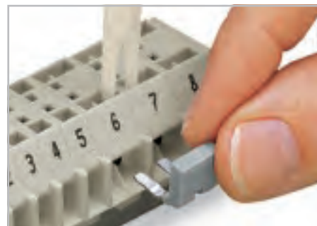
Объединение при помощи вставной перемычки.
