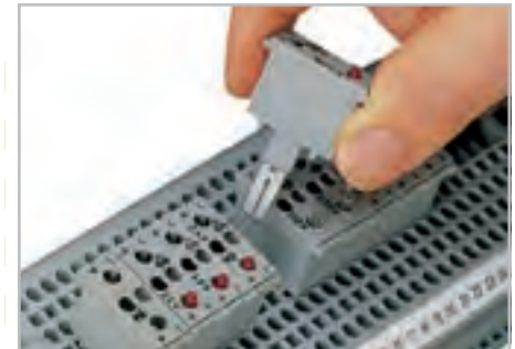
Съемные диодные модули на проходных клеммах с боковой маркировкой
