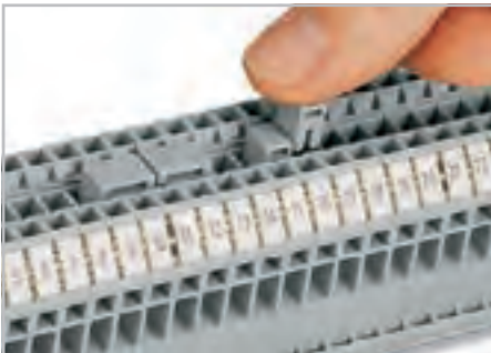
Объединение вертикальными поперечными перемычками.
