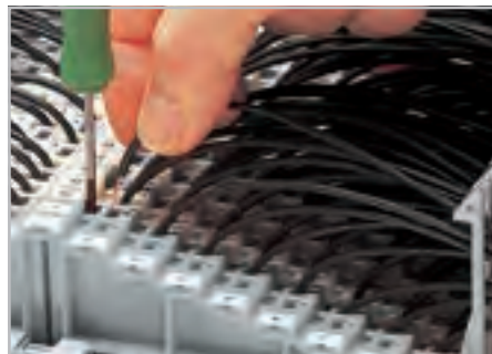
Заделка и удаление проводников с помощью рабочего инструмента (2,5 x 0,4) мм.
