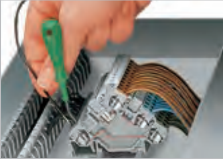
Присоединение проводника с помощью углового рабочего инструмента (210-658).
