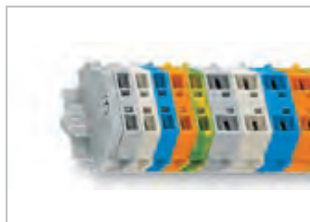
Клеммная колодка с крепежными фланцами, для винтового или аналогичного способа крепления, крепежное отверстие 3,2 мм Ø (с монтажным адаптером 209-123 также для DIN-рейки 35 мм)
