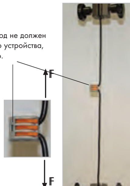
Схема испытаний для UL 486 C:
