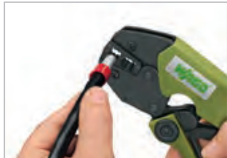
Вставьте проводник с наконечником в участок обжима.
