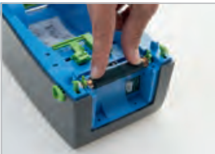
Вставьте и зафиксируйте подходящий ролик в принтере.
