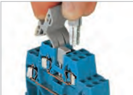
Объединение поперечными перемычками 280-402. Утопите поперечную перемычку до упора.
